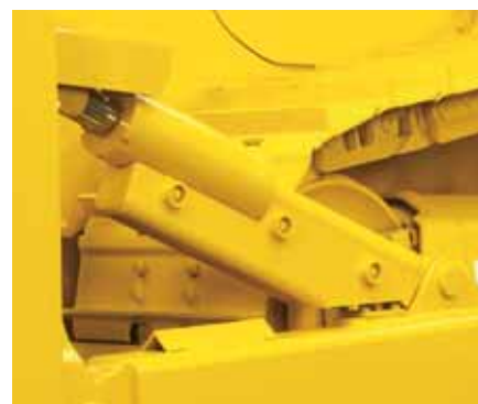
Le tubazioni idrauliche sono prevalentemente integrate nella struttura.
